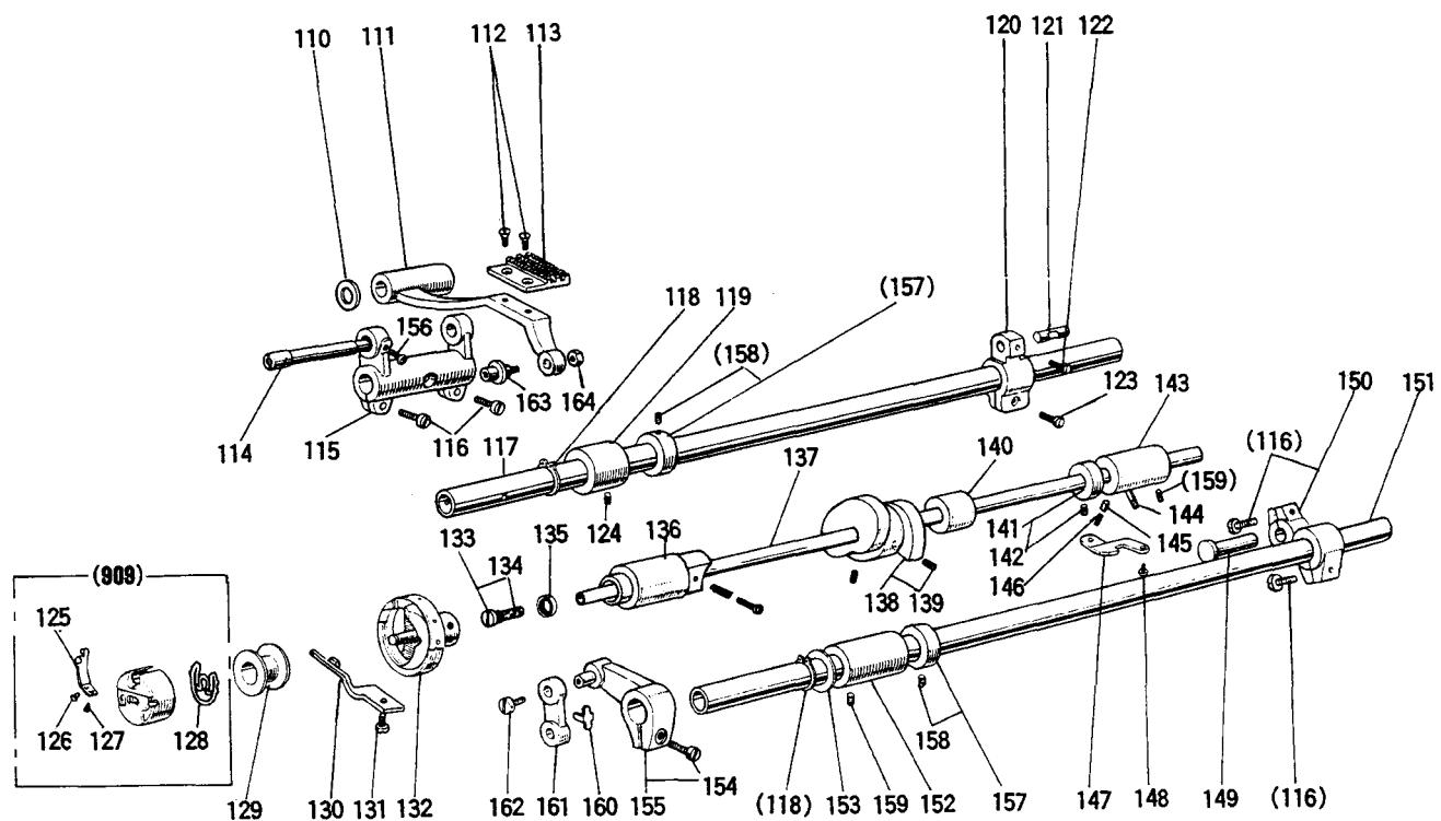
**④ 縫機構(Ⅱ)および水平送り軸, 上下送り軸機構
