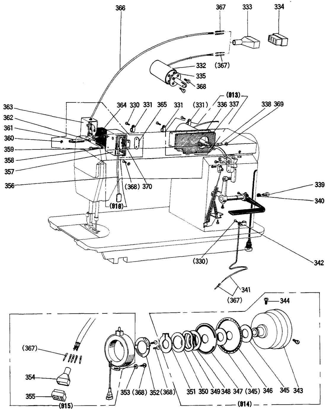
**⑧ タッチバック機構および検出器機構**
